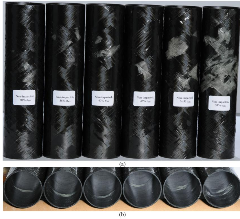
Şekil 4. Hibrit kompozit boru numunelerinin farklı gerilme değerlerinde yorulma sonrası hasarın a) dış yüzey ve b) iç yüzey genel görünüşü
